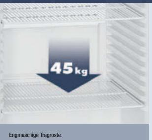
Die kunststoffbeschichteten Tragroste sind mit 45 kg extrem belastbar. Sie sind leicht höhenverstellbar und können bei 90° Türöffnung entnommen werden. Ihre engmaschige Ausführung gewährleistet optimalen Halt auch bei der Einlagerung kleiner Gegenstände.
